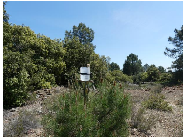
Illustration 2 : Pluviomètre installé sur les haldes supérieures de la verse
