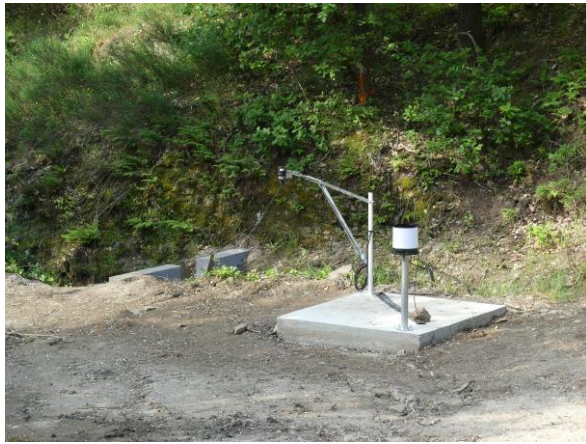
Illustration 41 : Station télémétrique et seuil de mesure de débit
