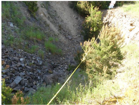
Illustration 29 : Mesure de diamètre au droit du fontis
